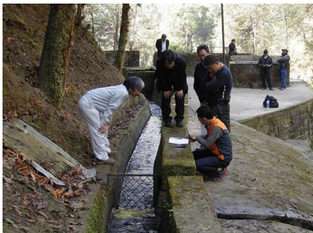
取水堰水路での簡易流量測定
