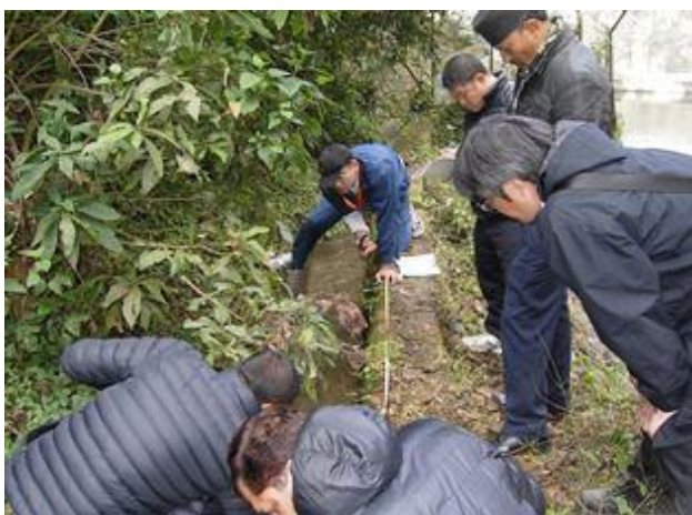
取水堰水路での簡易流量測定
