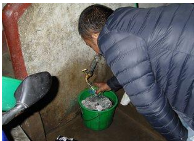
民家の蛇口 ボーデからの供給水 マノハラ浄水場からボーデ配水池経由で配水される水道水質は、ネパール国飲料水水質基準27項目全てに適合していた。
