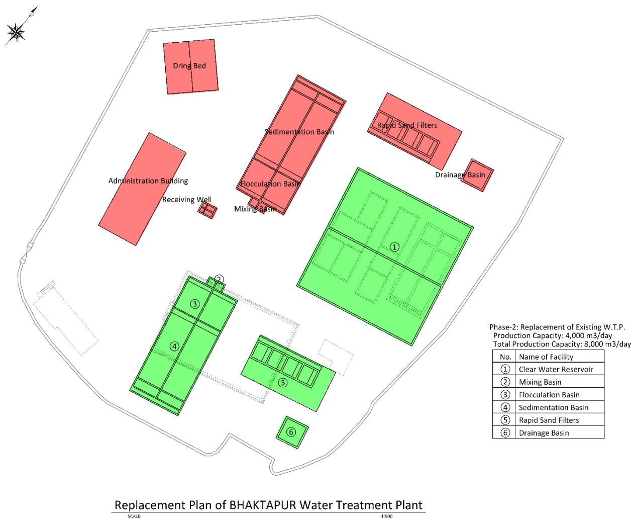
図 3.3.6 バンスバリ浄水場拡張(第 2 期工事)
