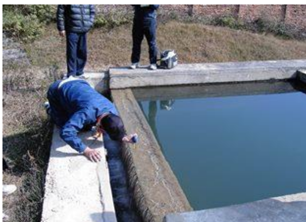
バンスバリ浄水場 沈殿池 流量測定
