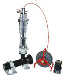
不断水管内調査カメラ
