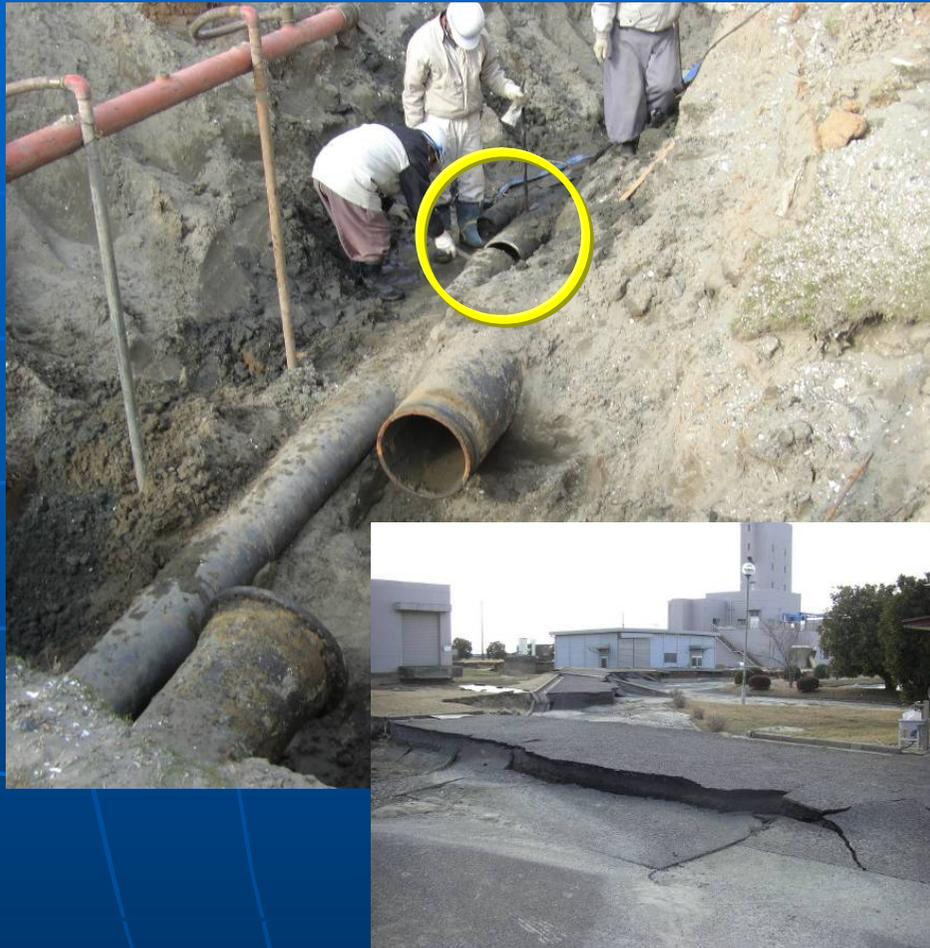
φ200 ダクティル鉄管 T形継手の離脱
