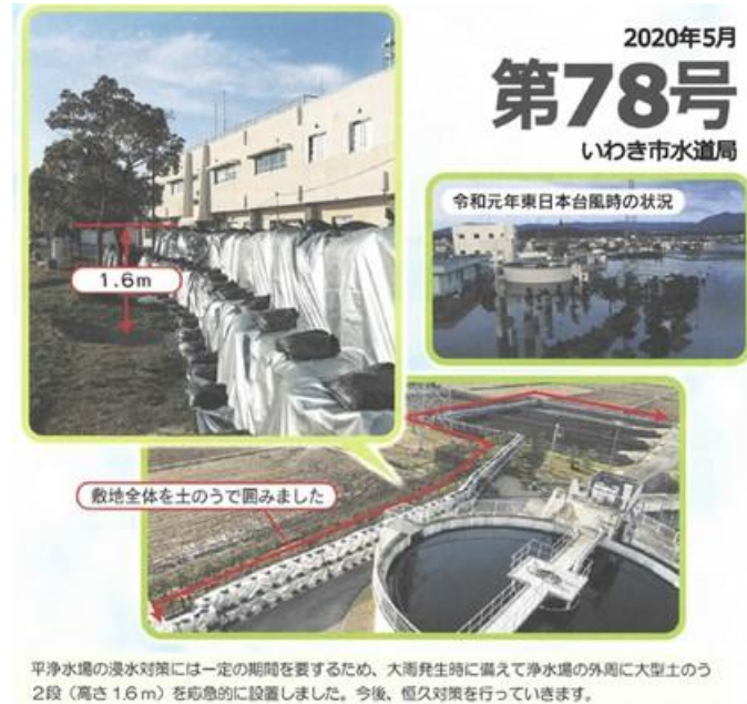
写真 4-1 施設外周に土のうを設置（福島県いわき市 平浄水場）
