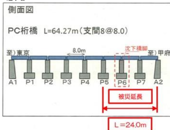
図 3-23 橋脚の沈下による添架管(送水管、配水管)の破損 (台風第19号; 山梨県大月市初狩町法雲寺橋)
