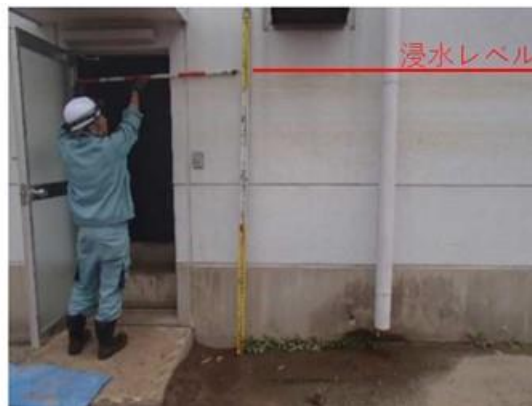
写真 3-5 電気室出入口付近浸水レベル（台風第 19 号；福島県いわき市 下平窪取水場）
