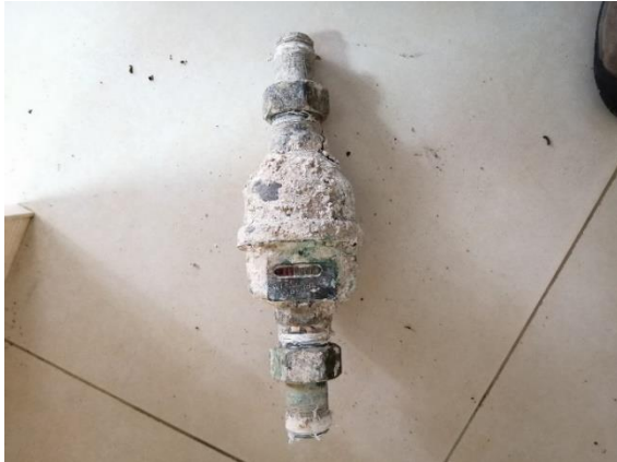
写真 2.8 スケールがこびり付いた従来の機械式のメーター
