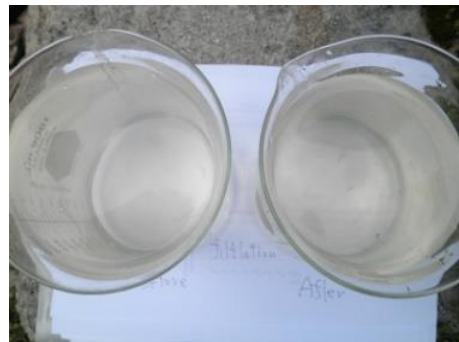
濁度の変化がない処理水 (左：ろ過前の原水、右：ろ過後の処理水)
