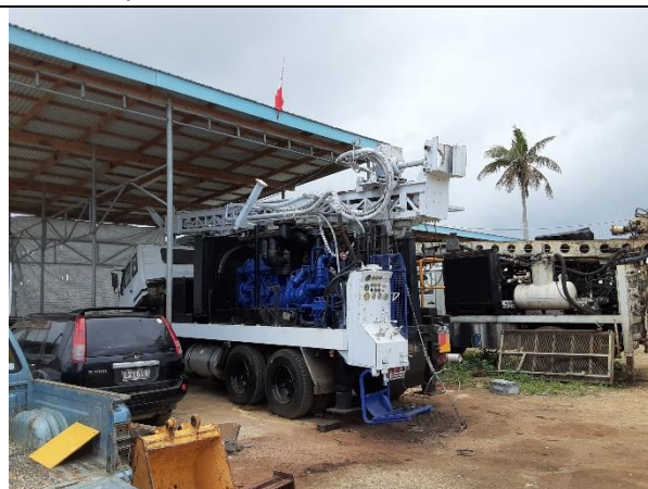
写真-34: 井戸掘削機(トンガタブ島)
