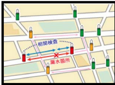
ロガー式漏水探索手法
