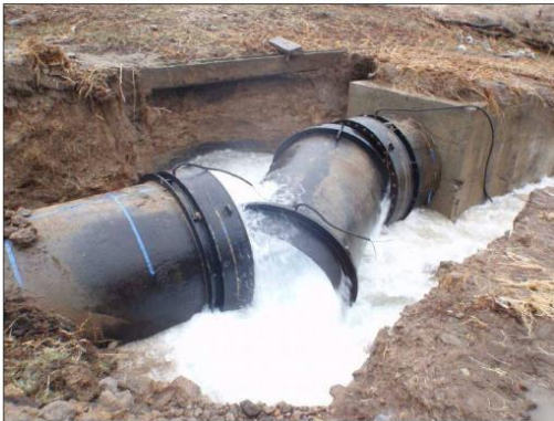
伸縮可とう管の抜け出しによる漏水発生
