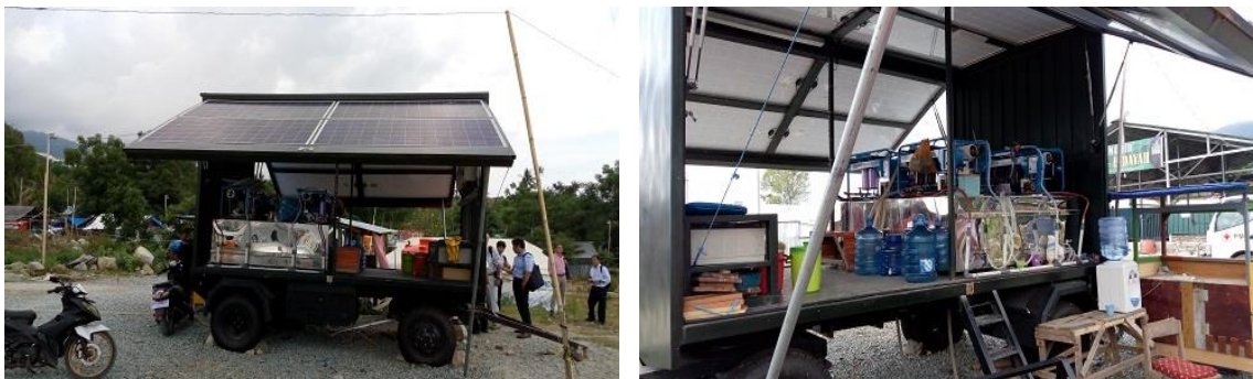
図 6.16 避難所に設置されている移動式浄水処理装置の写真 太陽光発電装置と膜ろ過装置が設置されている。
