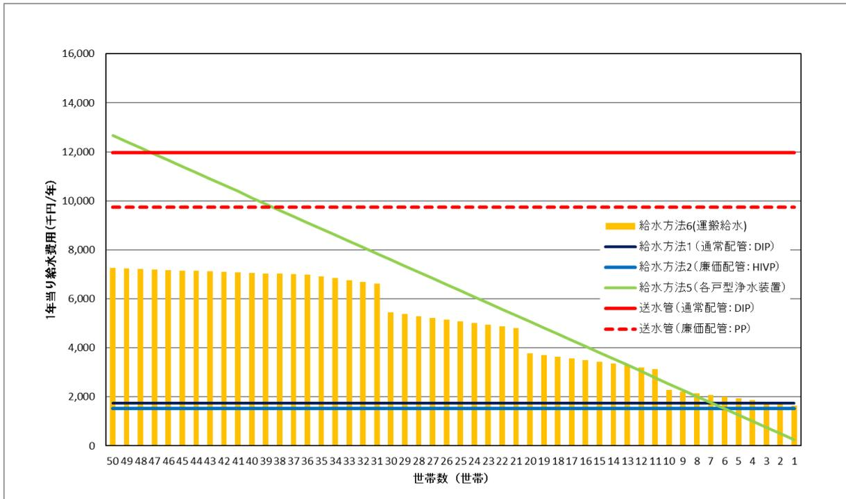
図 2.5.28 運搬給水における 1 年当たり給水費用（水道事業からの片道運搬距離・管布設延長：15km 管路維持困難区域内管布設延長：L=1.0km）
