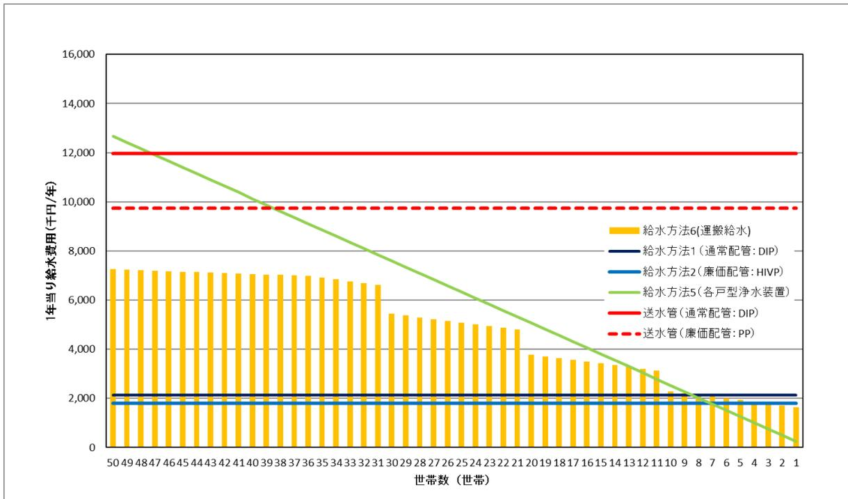
図 2.5.29 運搬給水における 1 年当たり給水費用（水道事業からの片道運搬距離・管布設延長：15km 管路維持困難区域内管布設延長：L=1.5km）
