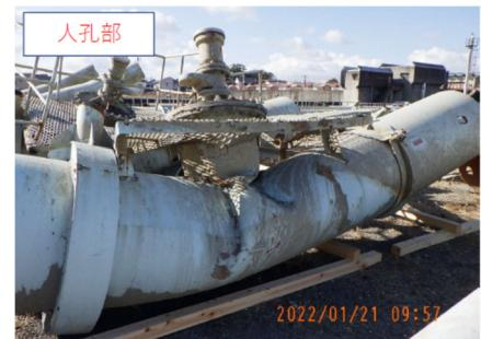
（座屈した空気弁付き人孔）
