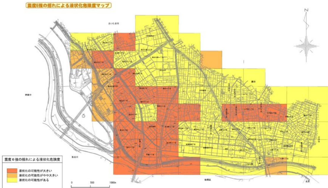
戸田市域における震度6強の揺れによる液状化危険度（資料:戸田市）
