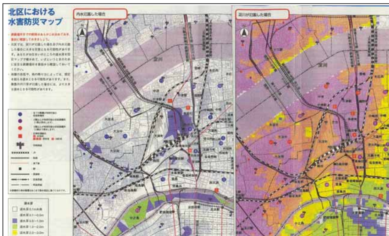
図7-8 内水と破堤，越水による氾濫の両方の浸水想定区域を表示した事例
