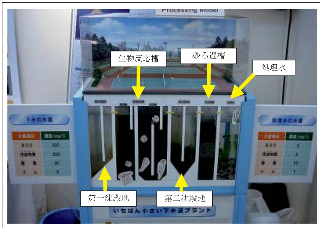
下水を第一沈殿地に入れ、第一沈殿地⇒生物反応槽（嫌気槽、好気槽）⇒第二沈殿地⇒砂ろ過槽と処理され、魚の棲める水質まできれいにできる。
