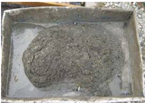
写真4-1 社会実験において採取された 伏越し内堆積物の状況
