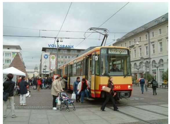
図3-12. カールスルーエにおける鉄道乗り入れ用のLRT車両
