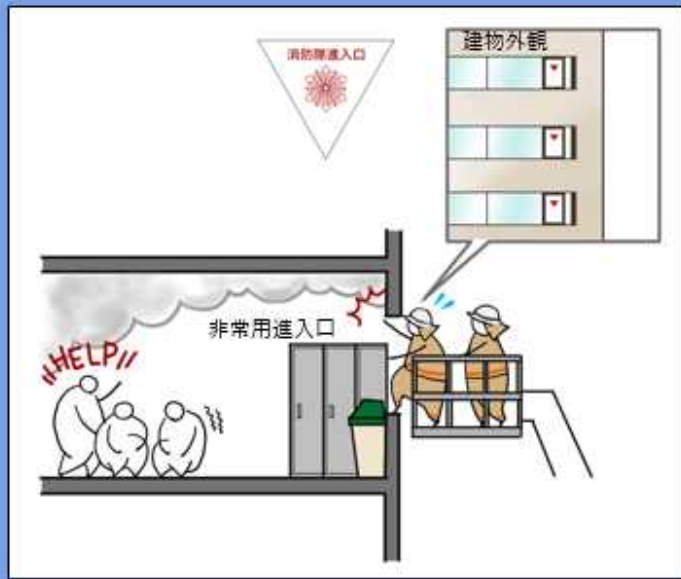
07. 非常用進入口に障害物がある状態
