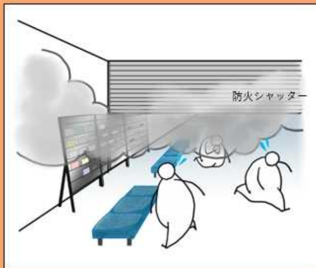
04. 防火シャッターが閉まらない状態
