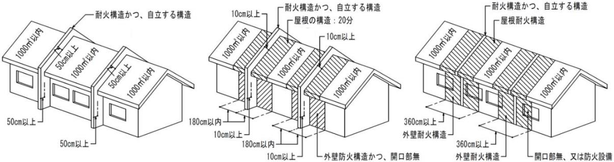
■防火床のイメージ図■ 令国国告第197号「防火壁及び防火床の構造方法を定める件」による
