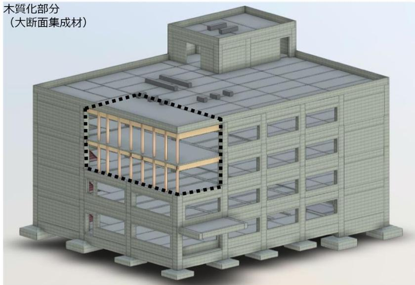
耐震壁付きRCラーメン構造の上層階の柱及び梁の一部を木造化した構造架構モデル（RC床）
