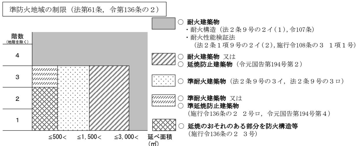
※ 施行令136条の2 1号ロに、耐火建築物と同等の耐火性能を有する建築物（延焼防止建築物）に関する規定があり、このうち一定の規模以下の建築物の範囲について令元国告第194号第2により構造方法が定められている。また、施行令136条の2 2号ロに準耐火建築物と同等の耐火性能を有する建築物（準延焼防止建築物）に関する規定があり、このうち一定の規模以下の建築物の範囲について令元国告第194号第4により構造方法が定められている。
