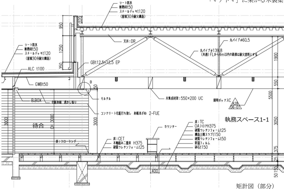
図 3.2.1.6 混構造による建築物の実例－3
