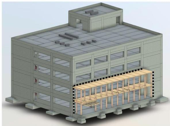
耐震壁付きRCラーメン構造の上層階の柱及び梁の一部を木造化した構造架構モデル（合板床）
