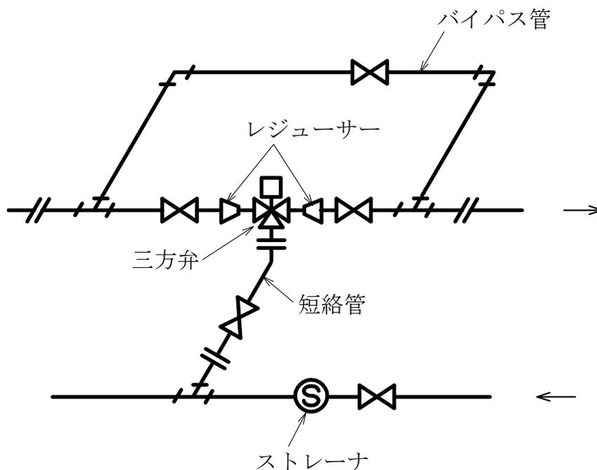
注 ストレーナ及び回り主管のGVは、主管と同一寸法とし、バイパス管、短絡管及び同用GVは、三方弁の接続口径と同径とする。
