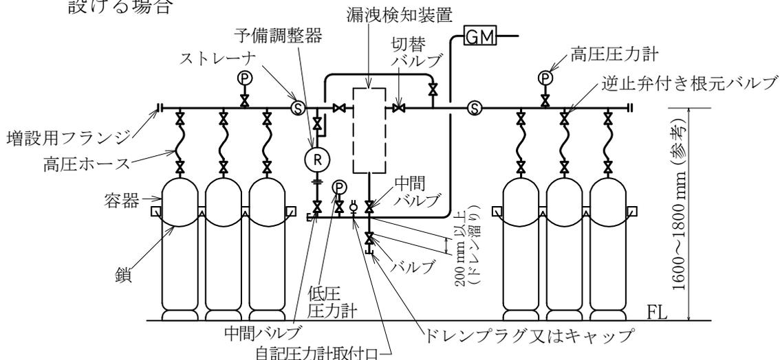
(イ) 圧力検知式漏洩検知装置を設ける場合
