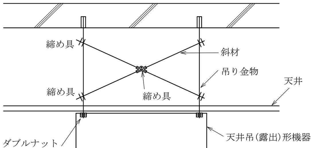
(b) カセット形機器の振れ止めの例
