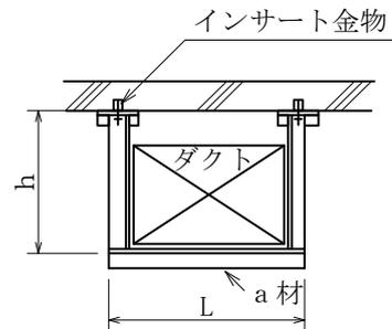
注 (2)の a 材及びインサート金物は、形鋼振れ止め支持部材選定表(一)の(c)による。
