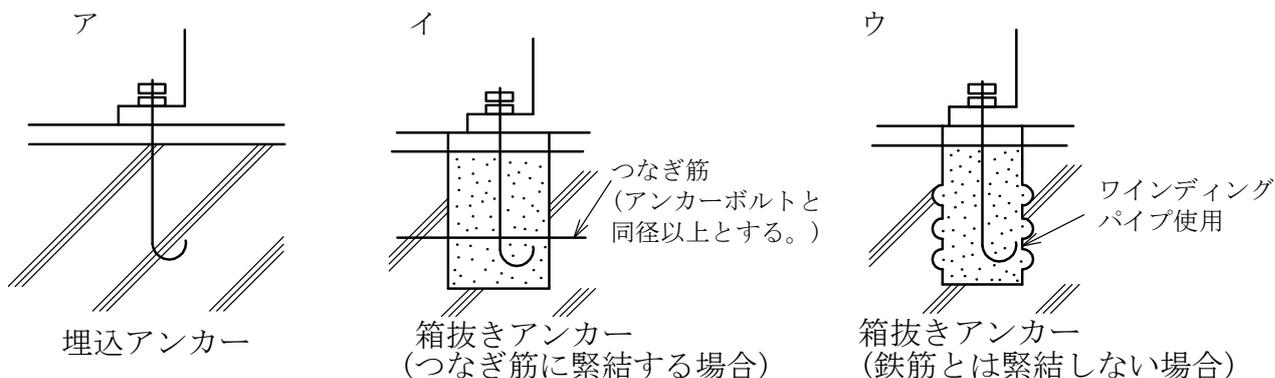
コンクリート基礎の高さとアンカーボルトの適用例
