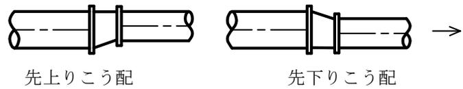
(f) リフト継手(蒸気配管)
