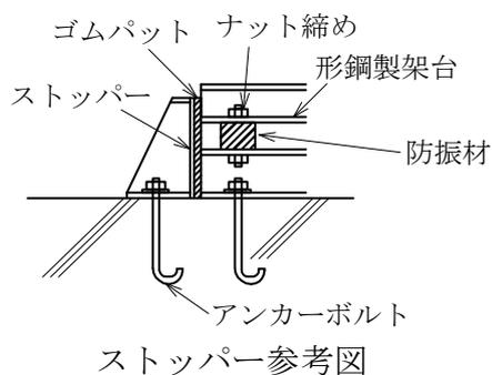
注 コンクリート基礎及びアンカーボルトの取付け方法は、基礎施工要領(一)による。
