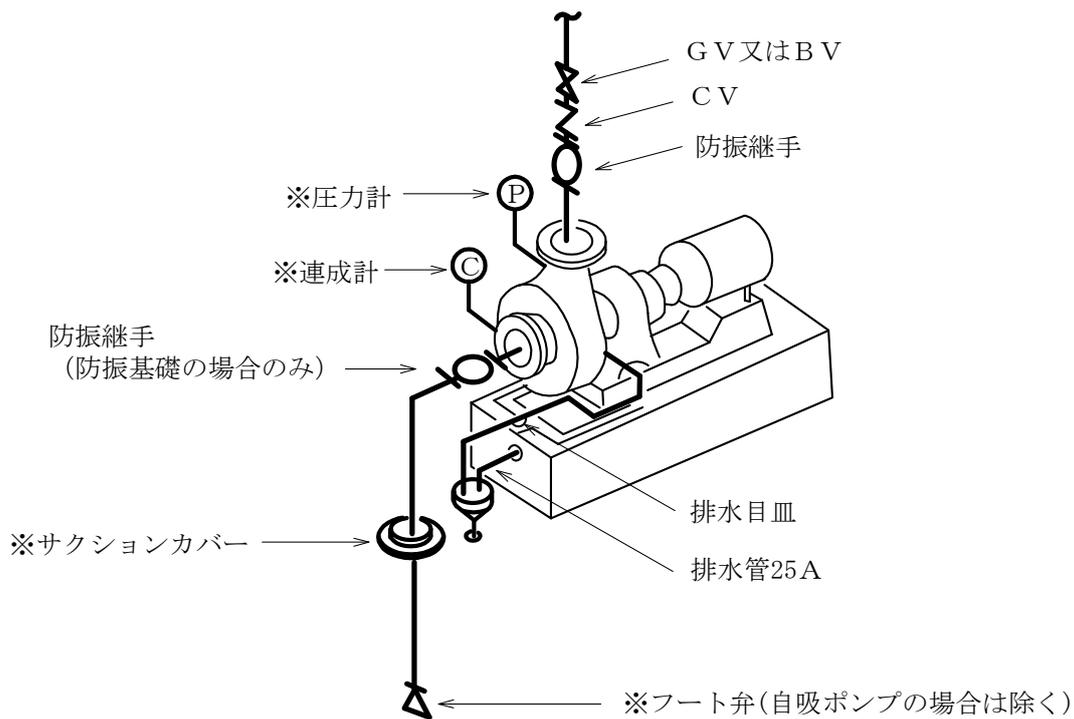
注 (ア) GV、BV、CV及び防振継手は、配管と同径とする。
