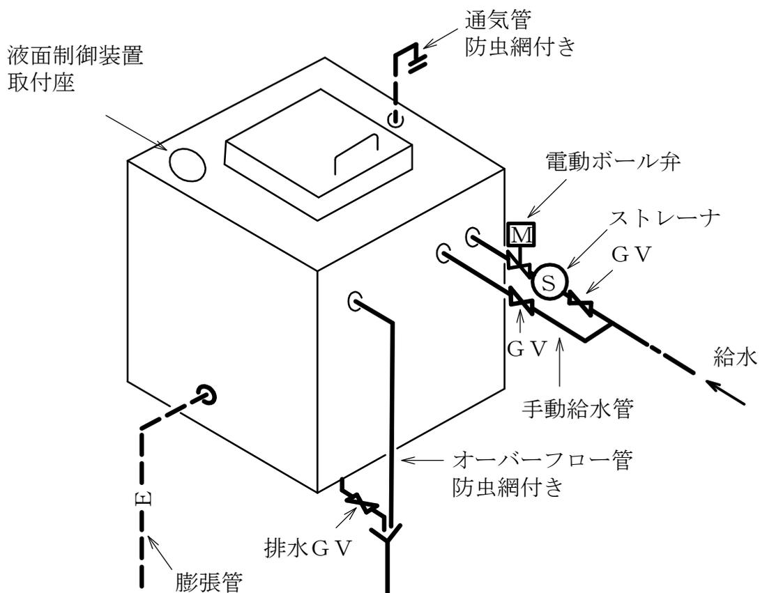
注 給水口とオーバーフロー口との間に吐水口空間を設ける。
