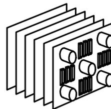
スリットフィン：平板に2×5～12mmのスリットを切り込んだもの
