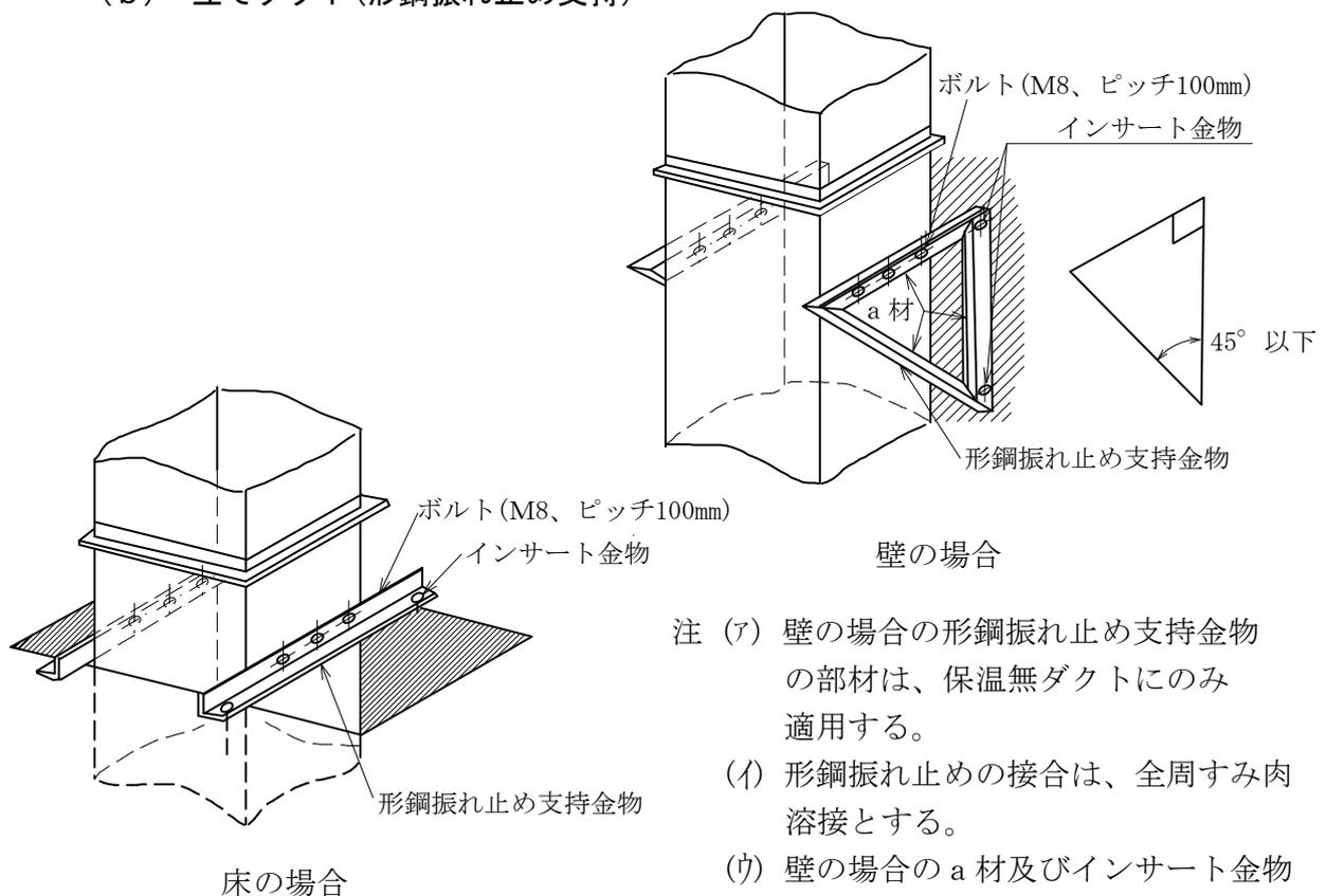
注 (ア) 壁の場合の形鋼振れ止め支持金物の部材は、保温無ダクトにのみ適用する。
