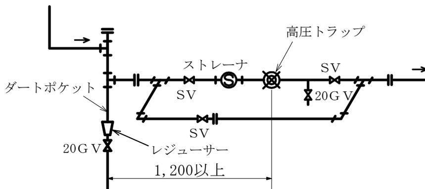
注 バイパス管及びダートポケットは、主管と同径とする。
