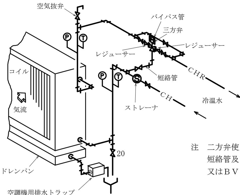
注 二方弁使用の場合、短絡管及び同用GV又はBVは除く。
