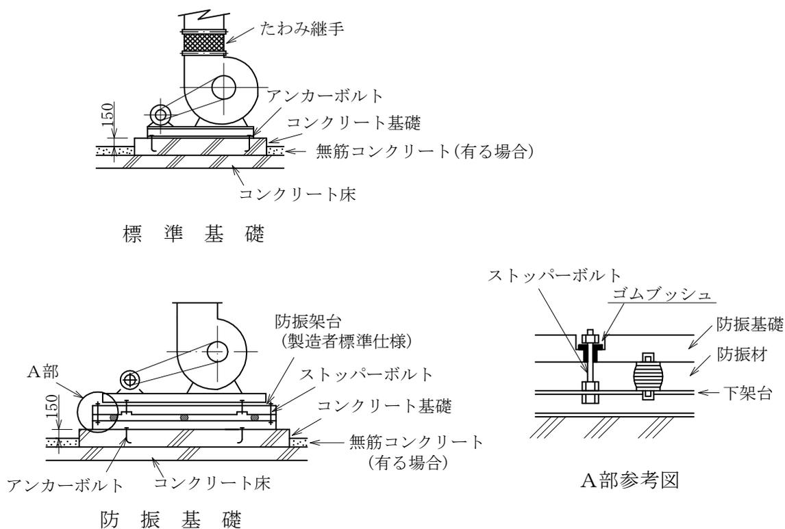
注 (ア) 防振材がスプリングの場合は、絶縁効率を80%以上とする(送風機(回転速度 $600\text{min}^{-1}$ 以上)の場合)。
