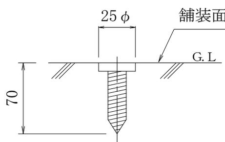
（図は舗装していない場合を示し、舗装した場合は地中埋設標の上面を舗装面に合わせる。）
