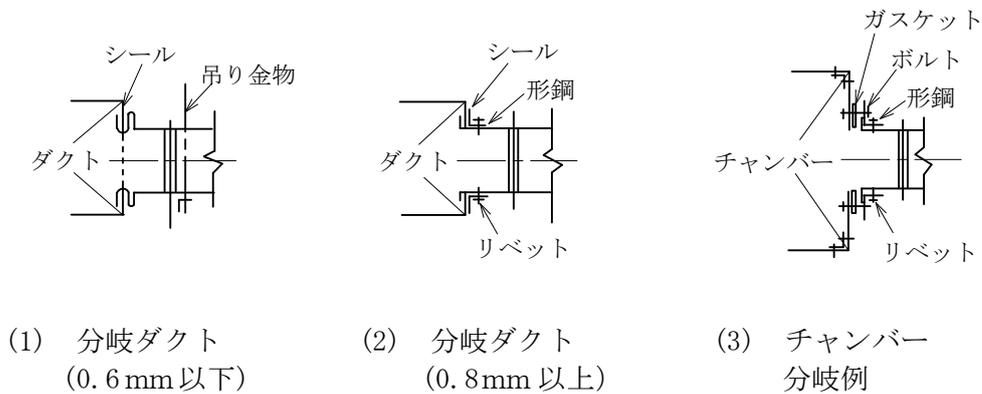
コーナーボルト工法ダクトのフランジ施工例（一）
