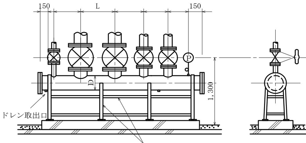
形鋼製架台又はパイプ架台
