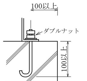
(c) アンカーボルトの取付方法の例
