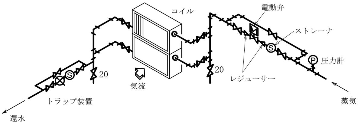
注 電動弁装置のバイパス管は、電動弁と同径とする。
