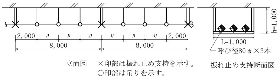
(1) 支持質量(配管質量)の算定(鋼管の呼び径80φの場合)
