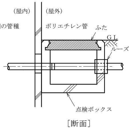
建築物導入部の変位吸収電気配管要領
