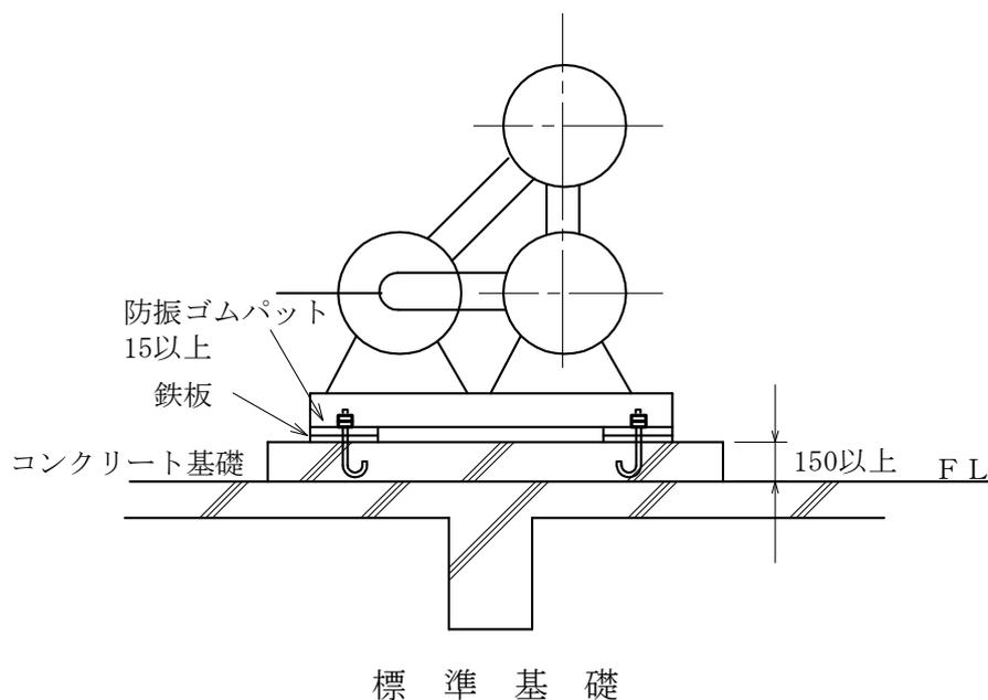
(b) 吸収冷凍機、吸収冷温水機及び吸収冷温水機ユニット
