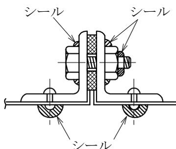
Cシール ダクトの組立構成材、補強材等の部品であるリベット、ボルト等がダクトを貫通する部分をシールする。
