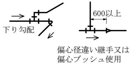
(d) 分岐(冷温水配管)
