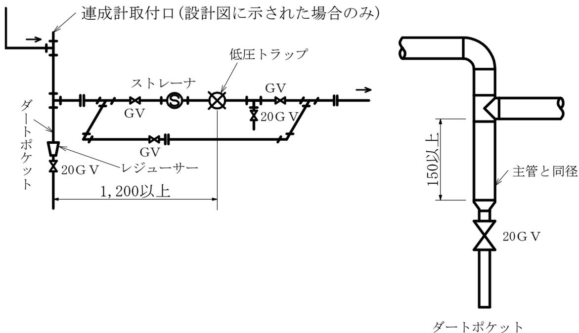
注 バイパス管及びダートポケットは、主管と同径とする。
