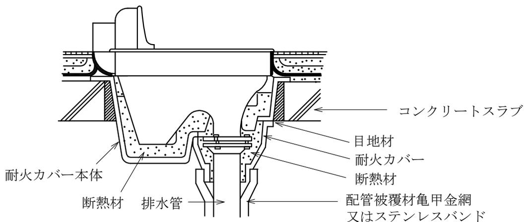
注 耐火二層管以外の接続管部分は耐火被覆する。
