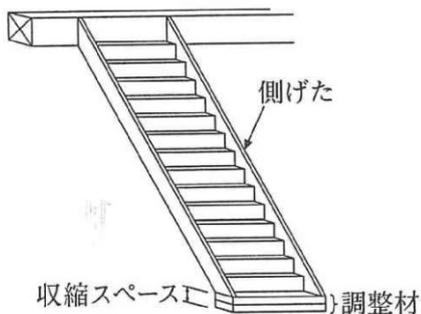
図8.9.5 階段の取付け
