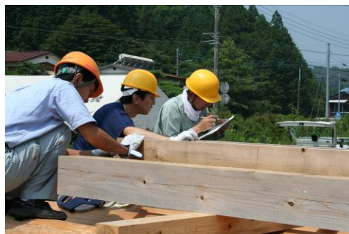
県林業センターと宇都宮大学の協力により実施した木材の強度試験の様子
