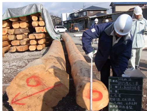
木材検査風景(2) マツ材
