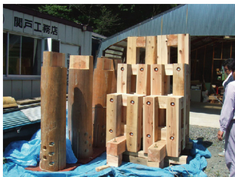
井桁試験体の製作
