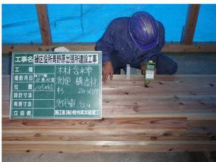
施工中の水分計による含水率測定
