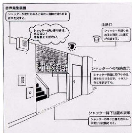
図3 - 1 防火シャッターの注意喚起装置
