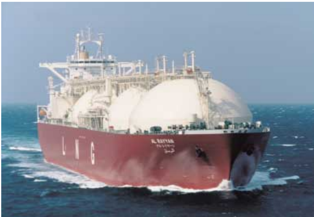
液化液化天然ガスを輸送するための特殊な船型を有する LNG 船「AL RAYYAN」
