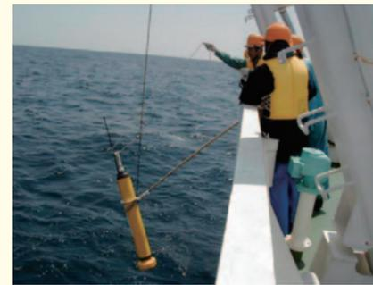
海洋気象観測船等により海洋に投入されたアルゴフロートはおよそ10日ごとに水深約2,000mまで自動的に降下・浮上を繰り返し、その際に測定される水温、塩分の鉛直データを、衛星を経由して送信する。
