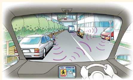
図表II-10-1-2 車車間通信システムのイメージ（先進安全自動車（ASV））
