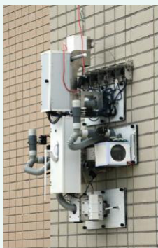
図3 建物の壁面を吸着して移動し、外壁を診断する装置の開発 資料) 国土交通省
