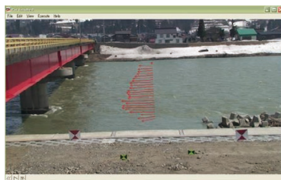
図1 CCTV映像を活用した画像解析による水位・流速把握（資料）神戸大学工学研究科 藤田研提供
