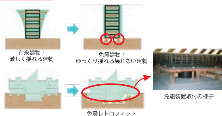
図表 I -1-2-16 免震構造の仕組み
