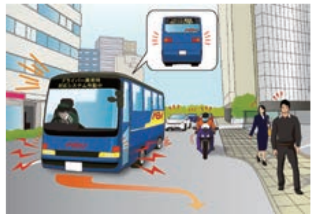
図表 II -10-1-2 ドライバー異常時対応システムのイメージ (先進安全自動車 (ASV))
