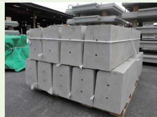
(注) CO<sub>2</sub>-SUICOM：コンクリートが固まる過程で二酸化炭素を吸い込み貯める二酸化炭素固定建材
