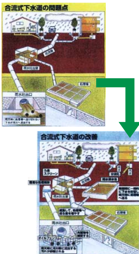
図1 合流式下水道の改善イメージ
