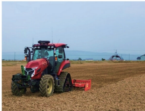
▲ スマート農業導入による生産性向上 (無人トラクターによる耕起：岩見沢市)
