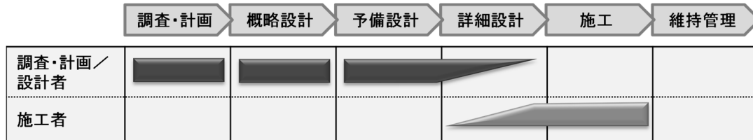
図-3.9 詳細設計付工事発注方式の適用段階（イメージ）
