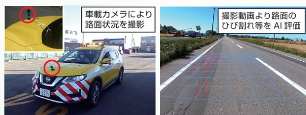
図23 AIを活用した舗装点検・診断
