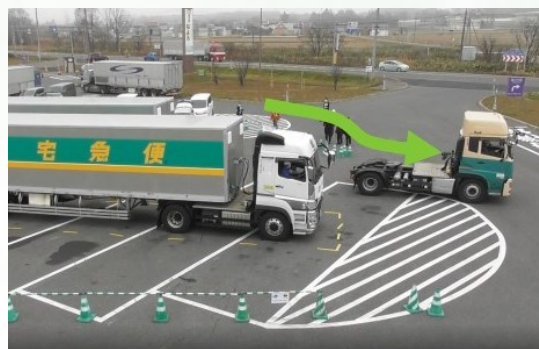
図16 実証実験の様子（トレーラーのヘッド交換）
