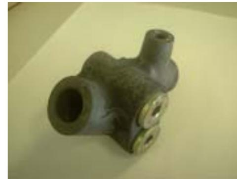
・高圧ほど腐食多いが、大気圧下でも腐食発生。
