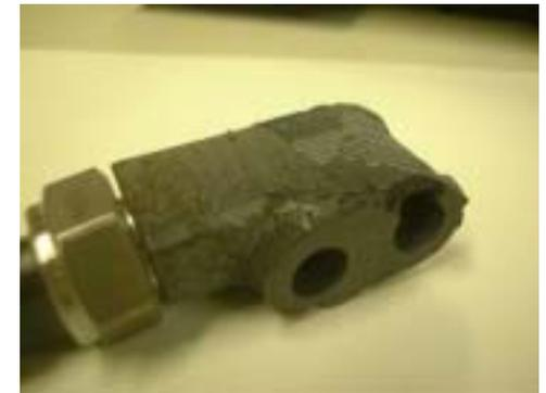
・72hrの短時間でほぼ全面腐食し、極めて強い腐食性を示した。
