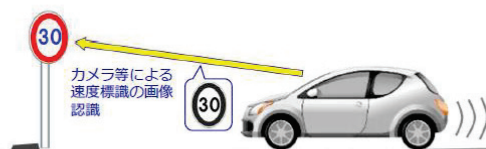
図 4-5 カメラ等で速度標識を読み取る例
