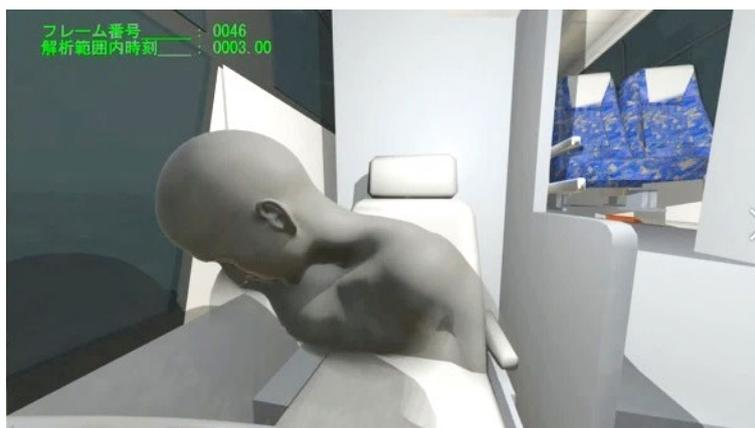
図 2-26 信号停止時に足元を見ている際に発生したうつむきの姿勢（高速バス、2秒以上継続、突っ伏しとしても検出されている）
