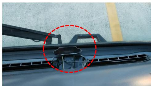
図 2-20 車外撮影用カメラ設置の様子
