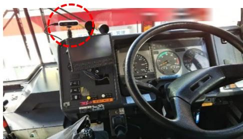
図 2-19 車内撮影用カメラ設置の様子
