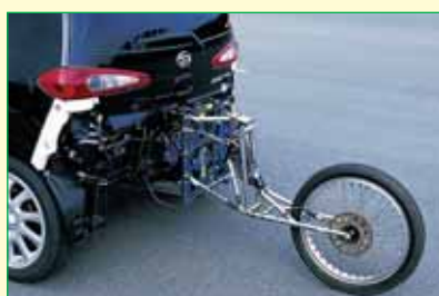
停止距離及び车速の測定装置を取り付けた試験車
