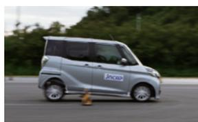
乾いた路面や濡れた路面で時速100kmから急制動を行い、停止距離や姿勢を試験します。
