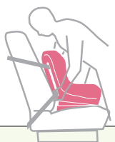
ベルトがねじれにくく、ぐらつきのないしっかりした固定を1人でもできるかを確認します
