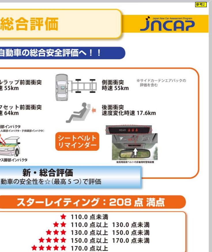
【★★★★★(5★)の追加必要条件】 5★を取得するためには、それぞれの衝突試験及び歩行者頭部保護試験において レベル4以上(後面衝突試験は薄緑色又は緑色)並びに歩行脚部保護試験において レベル3以上が必要。また、後面衝突試験は2012年度からはレベル4以上が必要となります。
