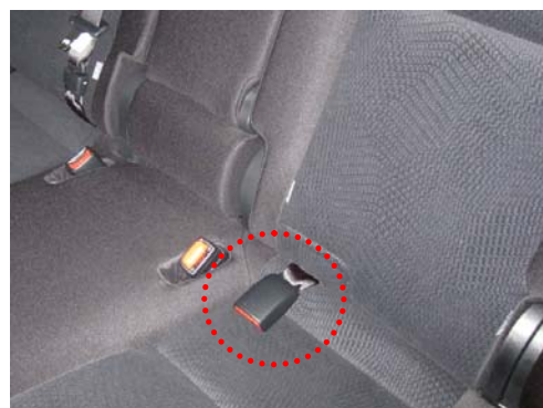
図2(中央席バックルが左外側座席乗員の臀部下になってしまう場合がある。
