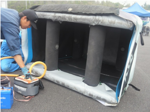
ターゲットへの空気の注入作業
