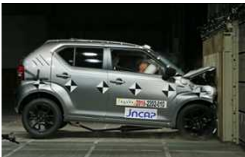
（前面衝突試験の様子）
