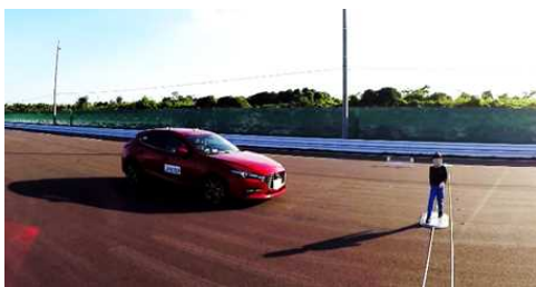
（対歩行者被害軽減ブレーキ試験の様子）
