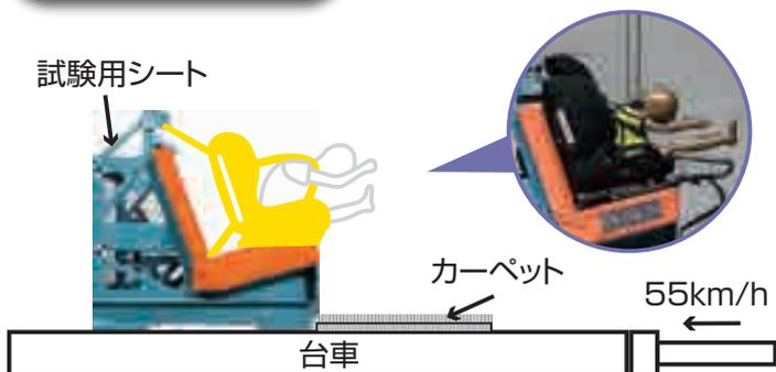
台車に固定された試験用シートに子供ダミーを乗せたチャイルドシートを取り付け、その台車を止まった状態から**時速55km**(国の安全基準の速度の1割増)になるように急激に後ろに打ち出すことにより、自動車が前面衝突した場合と同様の衝撃を発生させます。その時、チャイルドシートの取付部等の破損状況、ダミーの頭部や胸部の合成加速度、ダミー頭部の前方への移動量、ダミーの拘束状態の加害性などの項目を計測します。
