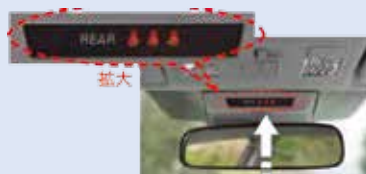
シートベルトの着用警報装置
