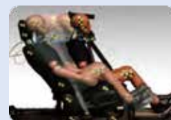
後面衝突頸部 保護性能試験
