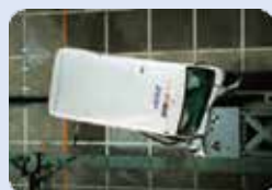
オフセット（部分） 前面衝突試験
