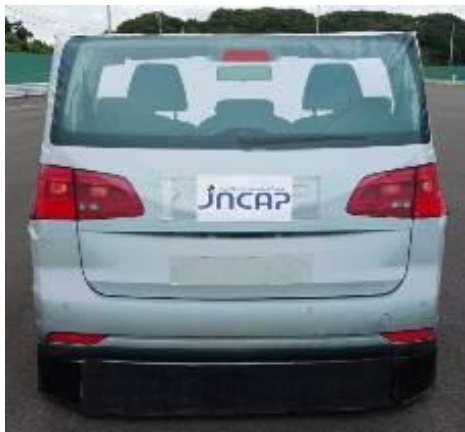
付図 1 試験用ターゲット (車両) の外観
