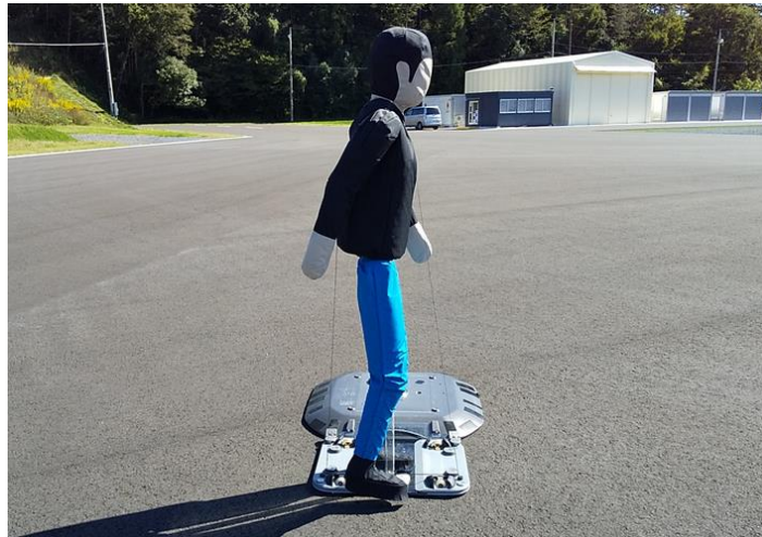
付図 A 試験用ターゲットの外観
