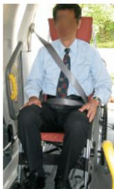
図 5-1 に 3 点式シートベルトの着用状況
