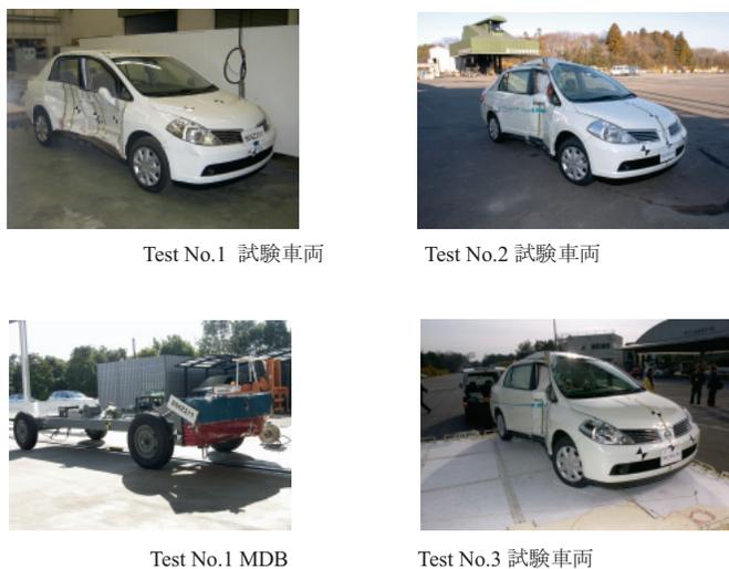
図8 テスト車及びMDBの変形状況 (Test No.1~Test No.3)
