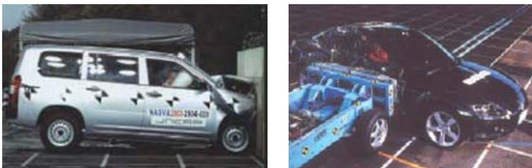
写真 フルラップ前面衝突試験(左)と側面衝突試験(右)<sup>15</sup>
