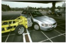
図 14 FMVSS214 の衝突試験
