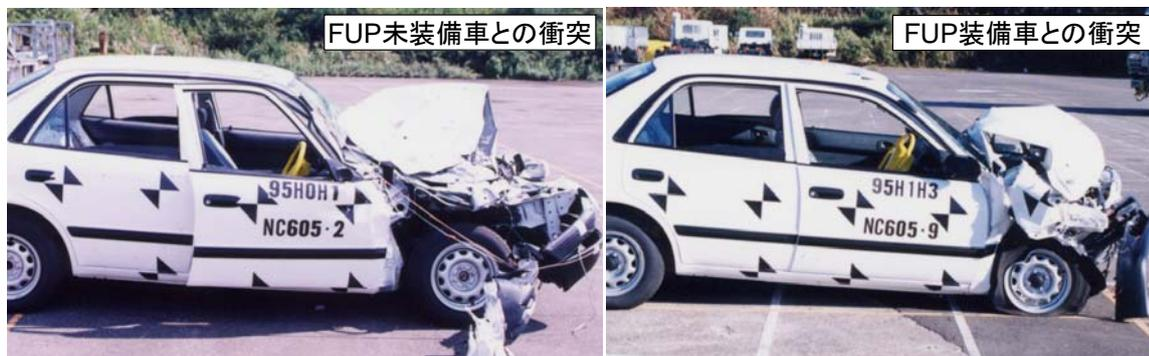
写真 乗用車の変形状況(大型トラックへのオフセット衝突)
