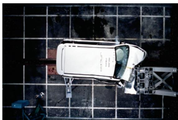
写真 オフセット前面衝突試験
