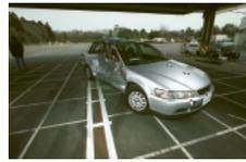
図 16 衝突実験後の試験車
