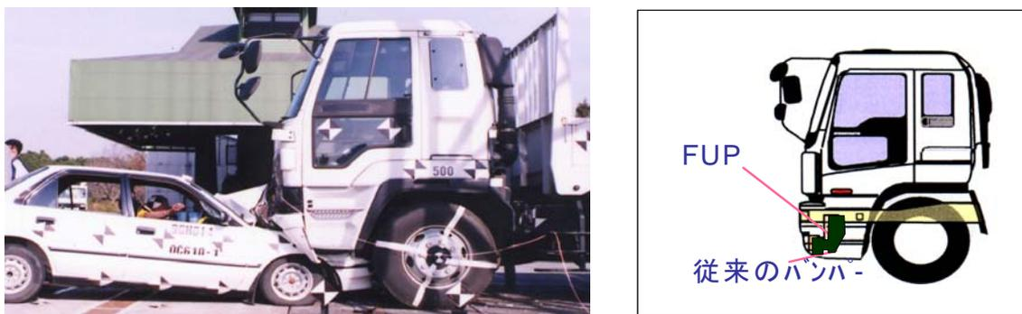
図 もぐり込み事故例(実車衝突実験)(左)と FUP の取付け位置(右)
