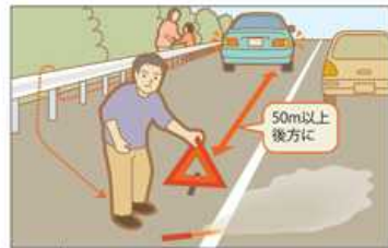
2 発炎筒、停止表示器材を車両後方に置く
