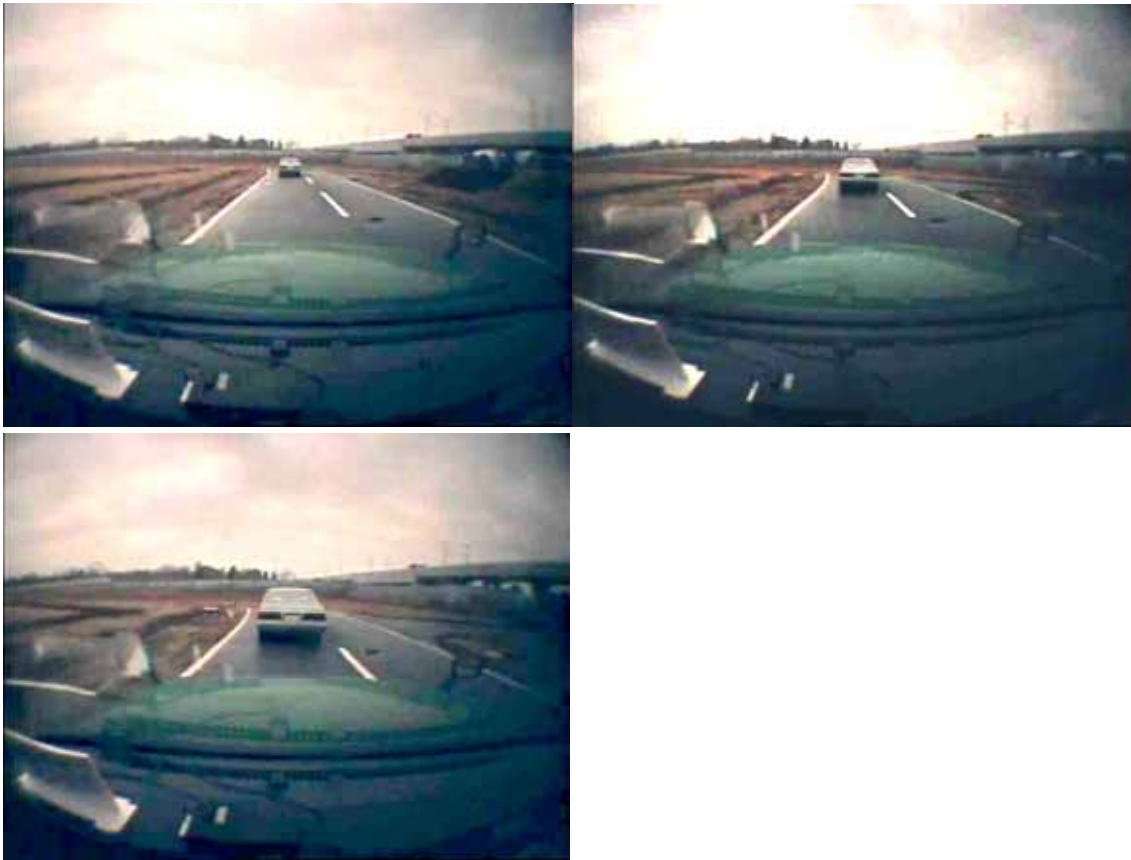
図D.14 映像による前方の先行車との車間距離（左上20m、右上10m、左下5m）
