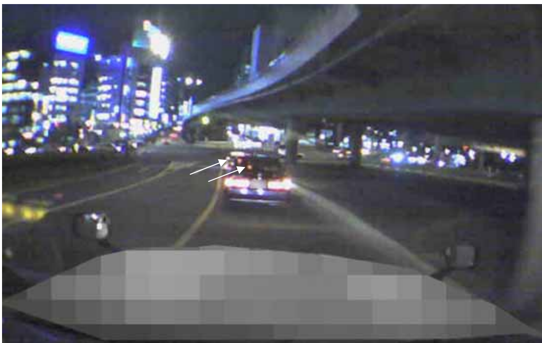
図D.11 先行車のリヤウインドウを通して見える先々行車のブレーキランプ（白矢印）
